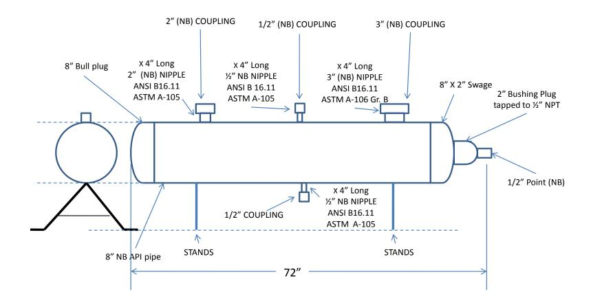
**TEST BENCH FOR TESTING SAFETY RELIEF VALVES**
