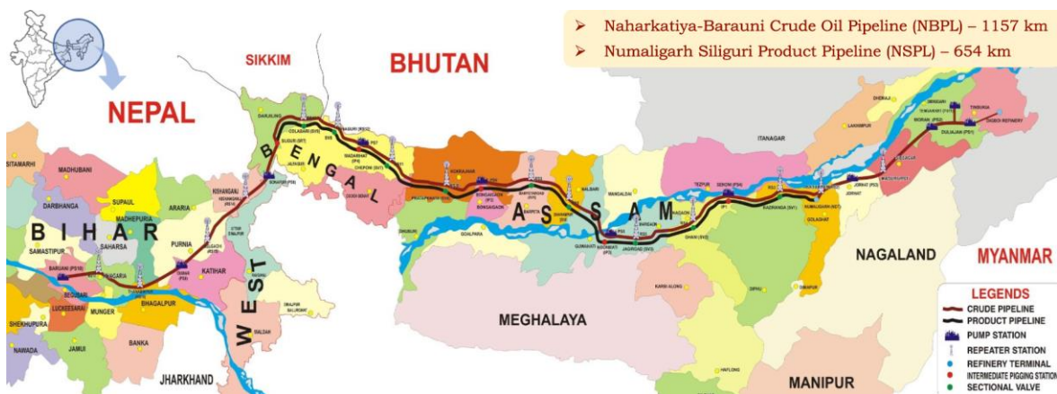
Fig: OIL’s pipeline network
